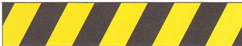
Figura 8 - Marcado de la señalización de seguridad para indicar la localización del peligro
