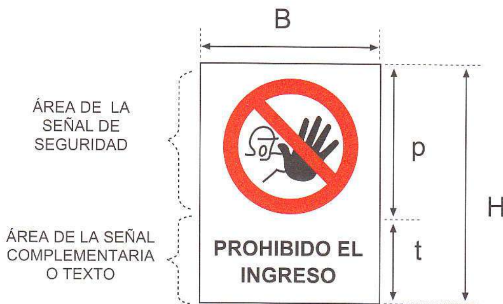
Figura 1b - Dimensiones de la señal de seguridad
