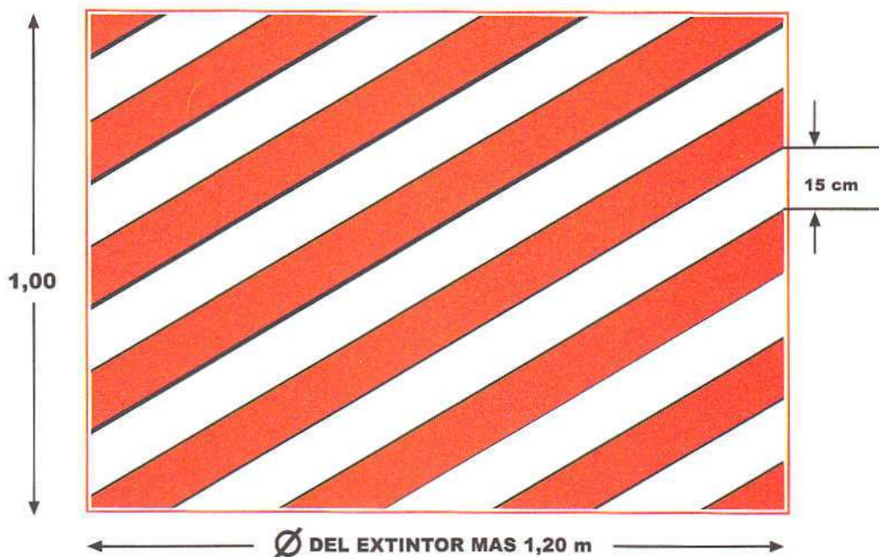
Figura 6b - Señalización horizontal o en el suelo debajo del extintor
