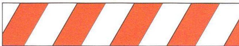
Figura 9 - Marcado de la señalización de seguridad para indicar la prohibición o localización de los equipos de protección contra incendios
