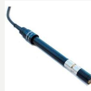
4. Realice una curva de calibración con las soluciones reguladoras preparadas o estándares de referencia con pH 4, 7 y 10, graficando pH leído (y) vs pH referencia (x)
