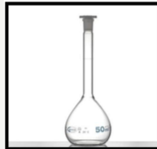
*Figura 2. Balón volumétrico*
