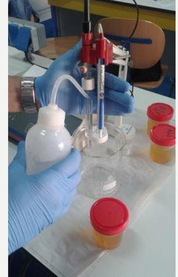
6. Permita que la lectura se estabilice asegurando que la membrana de intercambio este completamente sumergida y que las condiciones de agitación sean homogéneas
