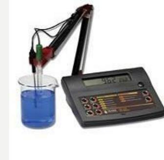
2. Saque los electrodos, de la solución de almacenamiento para electrodos
