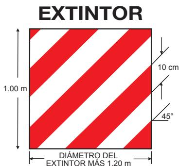
1.20 m de ancho adicionales al diámetro del extintor y como máximo 1 metro de la pared hacia adelante.
