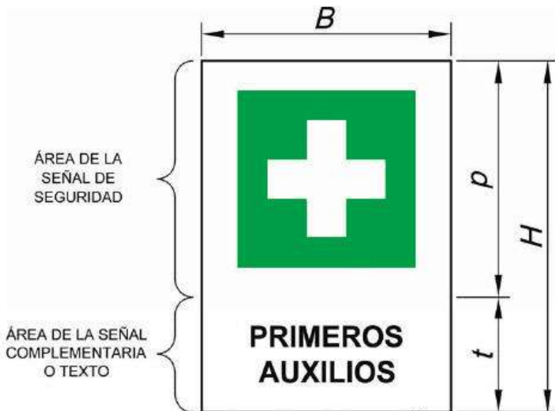
Figura 4b - Dimensiones de la señal en forma de cartel
