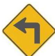
SP-1 CURVA PELIGROSA IZQUIERDA
