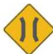
SP-44 PUENTE ANGOSTO
