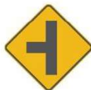
SP-19 VÍA LATERAL IZQUIERDA
