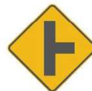
SP-20 VÍA LATERAL DERECHA
