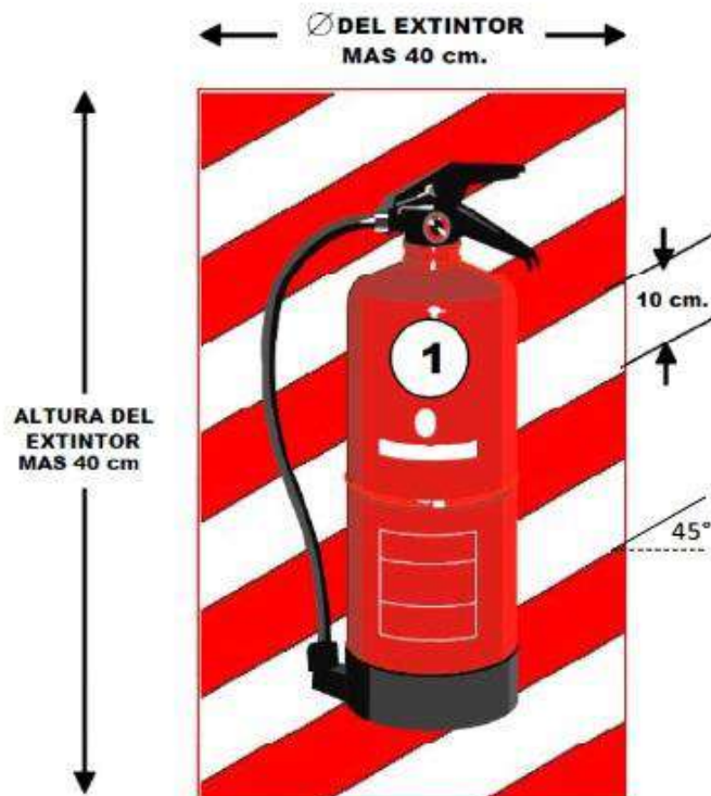
Figura 7a - Señalización vertical
