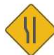
SP-42 ENSANCHE ASIMÉTRICO DE LA CALZADA (IZQUIERDA)
