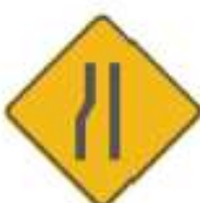
SP-40 REDUCCIÓN ASIMÉTRICA DE LA CALZADA (IZQUIERDA)
