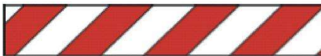
Figura 10 - Marcado de la señalización de seguridad para indicar la prohibición o localización de los equipos de protección contra incendios
