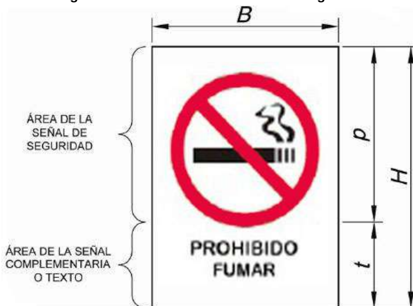
Figura 1b- Dimensiones de la señal en forma de cartel
