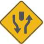
SP-62 INICIO VÍA CON SEPARADOR
