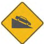
SP-16 PENDIENTE FUERTE DE BAJADA
