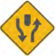
SP-62 INICIO VÍA CON SEPARADOR
