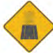
SP-63 FINAL DE PAVIMENTO
