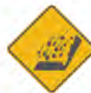
SP-49 ZONAS DE DERRUMBES
