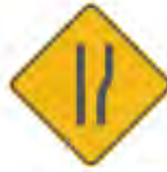
SP-43 ENSANCHE ASIMÉTRICO DE LA CALZADA DERECHA
