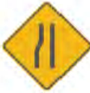
SP-40 REDUCCIÓN ASIMÉTRICA DE LA CALZADA IZQUIERDA
