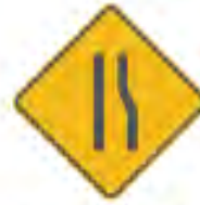
SP-39 REDUCCIÓN ASIMÉTRICA DE LA CALZADA DERECHA
