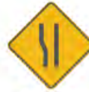
SP-42 ENSANCHE ASIMÉTRICO DE LA CALZADA IZQUIERDA
