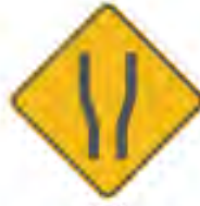
SP-41 ENSANCHE SIMÉTRICO DE LA CALZADA
