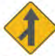
SP-29 INCORPORACIÓN DE TRÁNSITO IZQUIERDA
