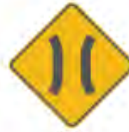
SP-44 PUENTE ANGOSTO
