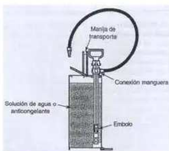
Figura D.4.1.3. Extintor de Tanque y Bomba
