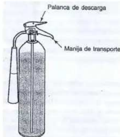
Figura D.4.3(b) Extintor de Dióxido de Carbono
