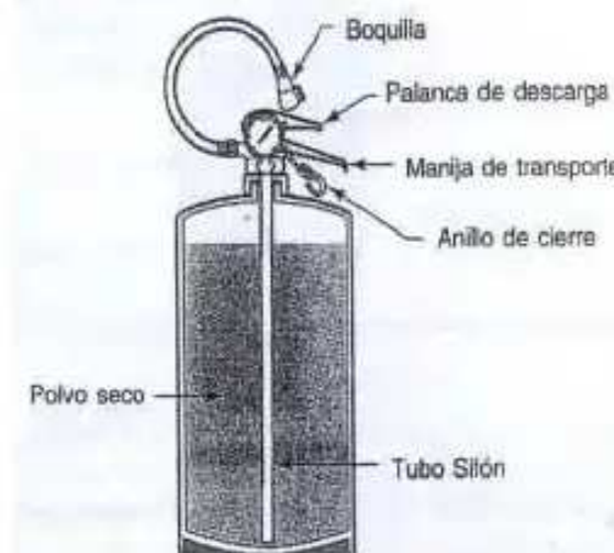
Figura D.4.5.(a) Extintor Presurizado de Químico Seco
